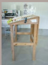
L'inclinaison de la table de tri facilite l'observation des œufs et limite les gestes et postures contraignants.
